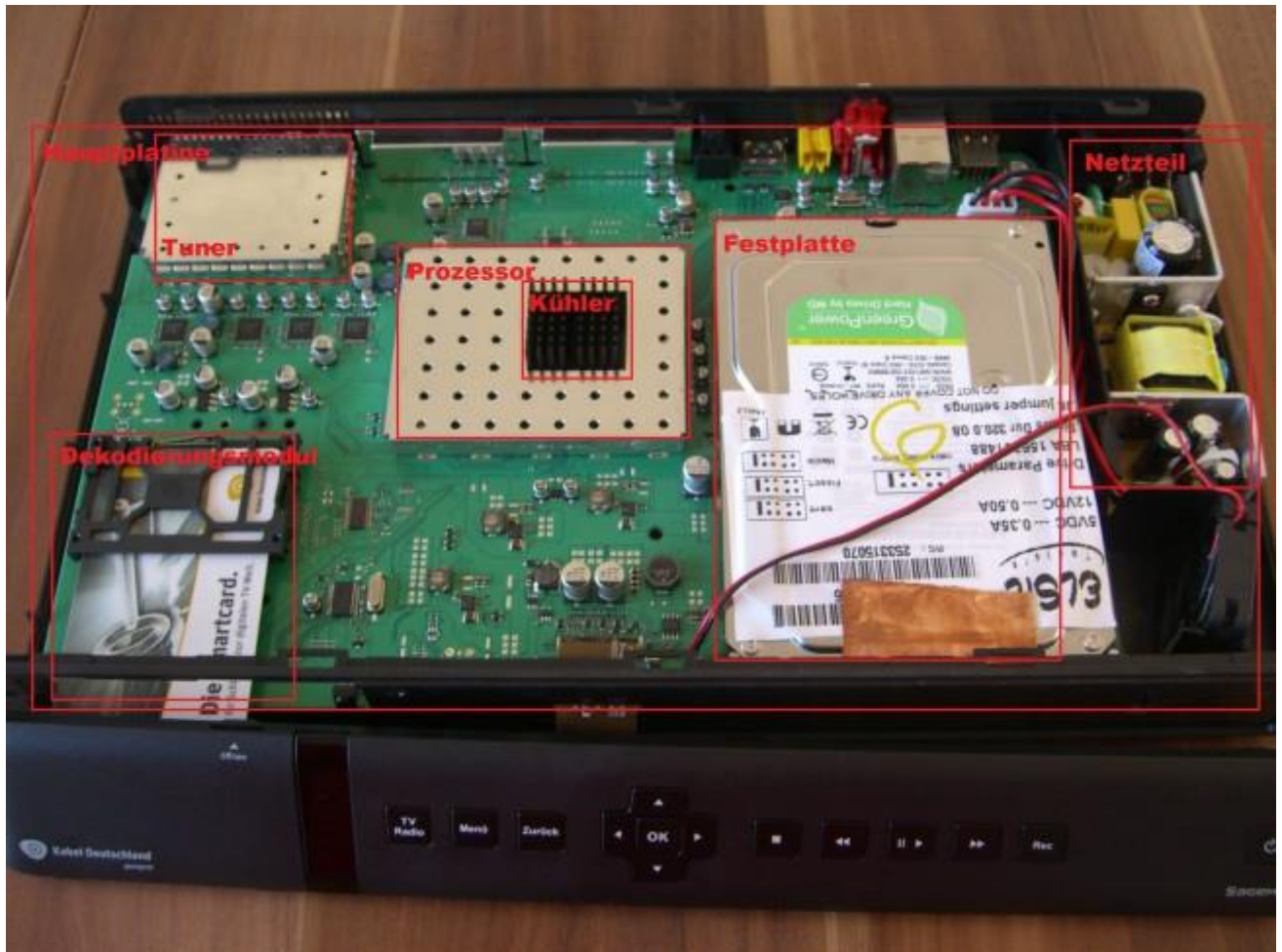
Kabelreceiver Komponenten und Innenleben
