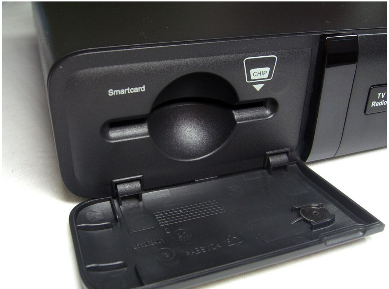
Smartcard-Schacht des Sagemcom RC188-320 KDG
